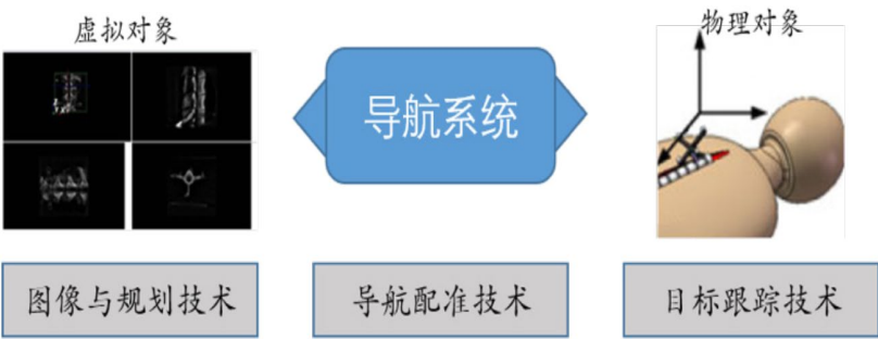
图32：导航系统是骨科手术机器人关键组成之一
